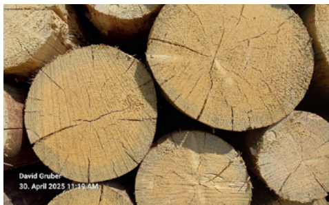
Stark rissiges Holz
